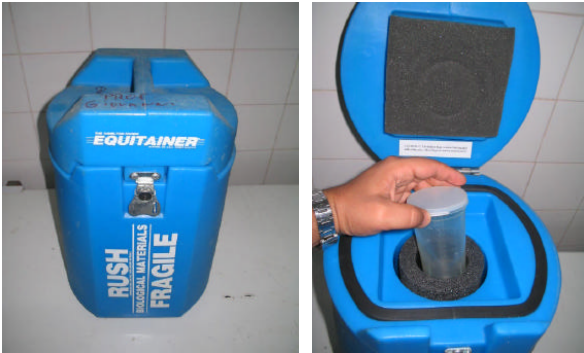
Figura 2 – Equitainer®, sistema passivo de resfriamento de sêmen, utilizado para a realização da CR1.
