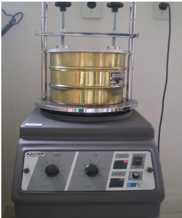
Figura 2 - Agitador elétrico de peneiras granulométricas.
