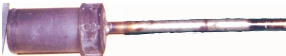
Figura 1: Retorta metálica, usada para a carbonização do material vegetal.
