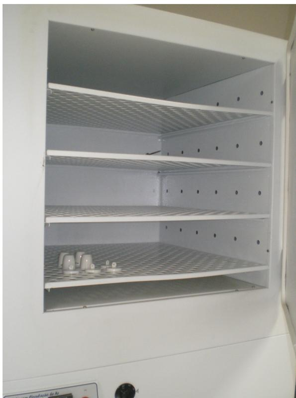
Figura 3 – Interior da estufa de circulação forçada de ar.
