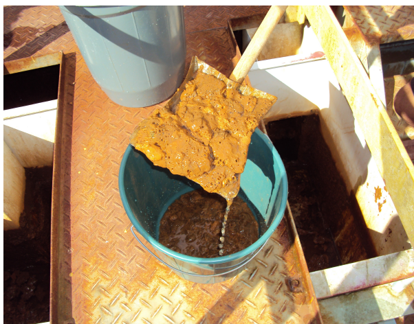
Figura 1: Lodo existente na estrutura do decantador e floculador da ETA do Campus. Fonte: Os autores.
