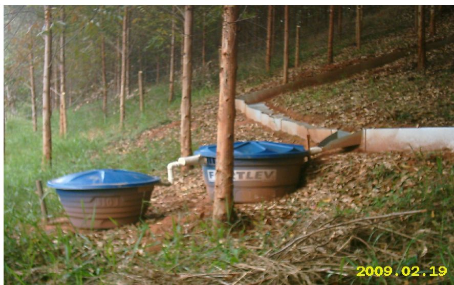
Figura 2 – Tanques de coletas de sedimentos, com vista parcial da parcela padrão. Fonte: Os autores.
